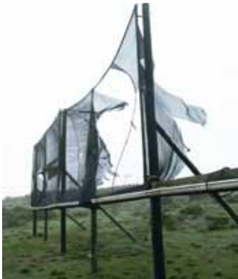
Foto 3.12: La presión del viento puede generar una ruptura extensa de la malla cuando las fuerzas exceden la resistencia a la tracción de las fibras. Esta ruptura generalmente se inicia en zonas localizadas, pero a partir de ahí se activa un proceso progresivo de desintegración de la malla. (R. Holmes)
