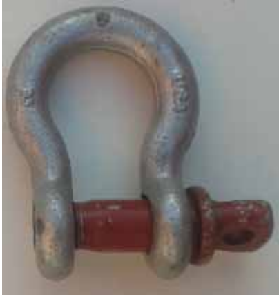
Foto 4.27: Fijación con grillete (Proyecto Atrapanieblas).
