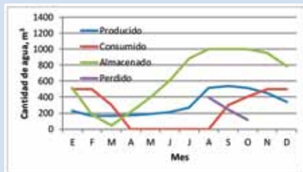
Fig. 3.5: Abastecimiento de agua para riego con 50 atrapanieblas de 150 m 2 cada uno y con almacenamiento de agua de 1.000 m 3 de capacidad.
