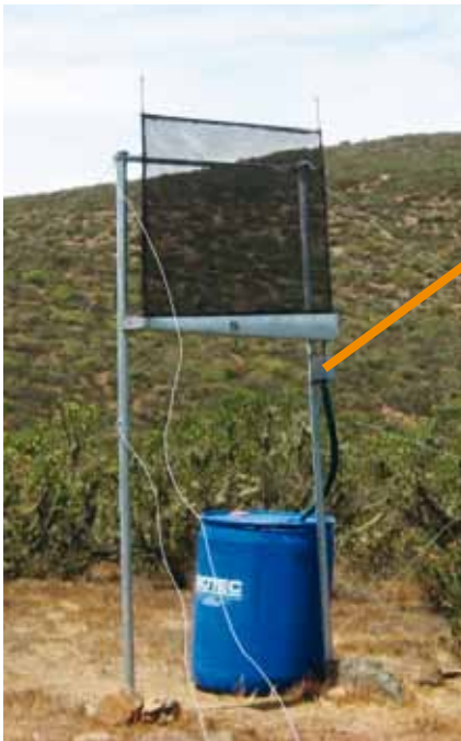
Foto 2.3: Pluviómetro montado en neblinómetro. Majada Blanca (Proyecto Atrapanieblas).
