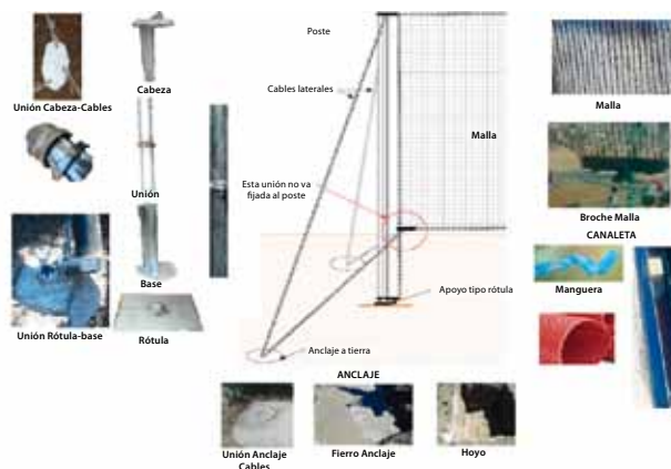
Fig. 4.1: Parte y piezas para construcción de atrapanieblas. (Proyecto Atrapanieblas)
