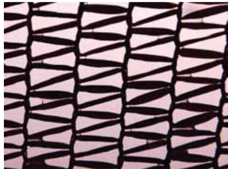
Foto 3.1: Mallas de acero inoxidable y Raschel con gotas de agua que cubren parcialmente las aberturas, bloqueando el flujo de niebla. Peñablanca (Chile), Julio de 2013 (María Tou y John Freidah).
