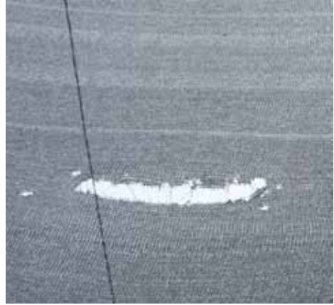
Foto 3.10: La ruptura también se puede iniciar en zonas alejadas de las fijaciones y sus características dependerán del comportamiento anisotrópico de la malla (Proyecto Atrapanieblas).
