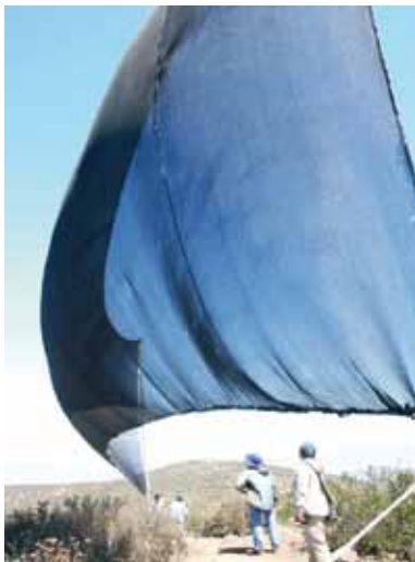
Foto 3.8: Deformación de la superficie de colección por embolsamiento debido a la presión del viento. A una misma presión del viento, las deformaciones pueden variar según la resistencia a la deformación plástica o elástica de las fibras o por desplazamientos de las fibras en la retícula de la malla (Proyecto Atrapanieblas).
