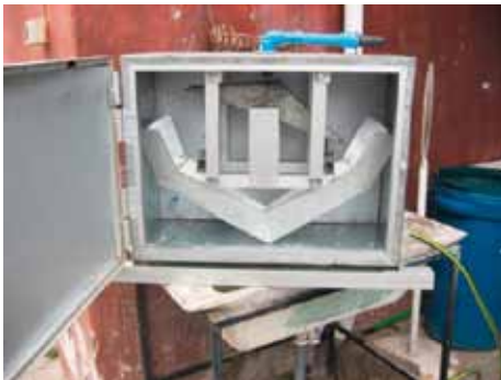
Foto 2.7: Medidor de flujo (Tipping Bucket). El agua de atrapaniebla entra arriba por el tubo. Cuando la "cuchara doble" está llena en un lado, se gira para drenar y empezar a llenar en el otro lado. Una cuenta de giros indica la acumulación de agua por el atrapaniebla. (Foto R. LeBoeuf, diseño Nazareno Carvajal).
