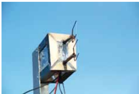
Foto 2.6: Prototipo de la sonda de flujo de agua líquida. Se usan alambres calientes para la medición del flujo de agua líquida en niebla. Reserva Cerro Grande, Comunidad Agrícola de Peña Blanca, Región Coquimbo, Chile (R. LeBoeuf).
