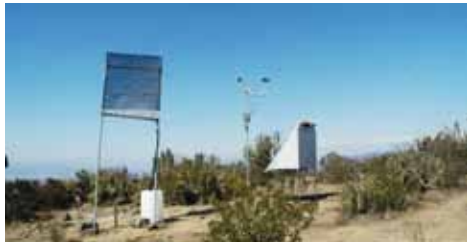
Fotos 1.17 y 1.18: SFC con medición manual en Patache (1997) y SFC con medición automática de agua (pluviómetro) y viento (veleta y anemómetro) en cerro frente a Totoralillo (2013). (P. Cereceda).
