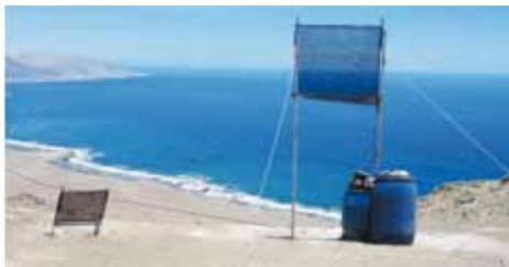
Fotos 1.17 y 1.18: SFC con medición manual en Patache (1997) y SFC con medición automática de agua (pluviómetro) y viento (veleta y anemómetro) en cerro frente a Totoralillo (2013). (P. Cereceda).
